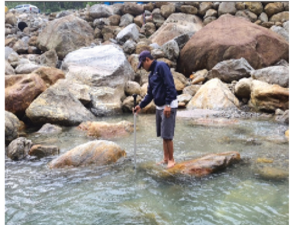
Global Flow Probe Current Meter को सहायताले वातावरणीय प्रवाह मापन गर्दै
