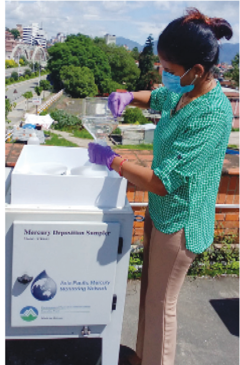
wet deposition विधिबाट पारो अध्ययनका लागि rain water को नमुना संकलनका लागि उपकरण जडान गरिदै, वातावरण विभाग, बबरमहल
