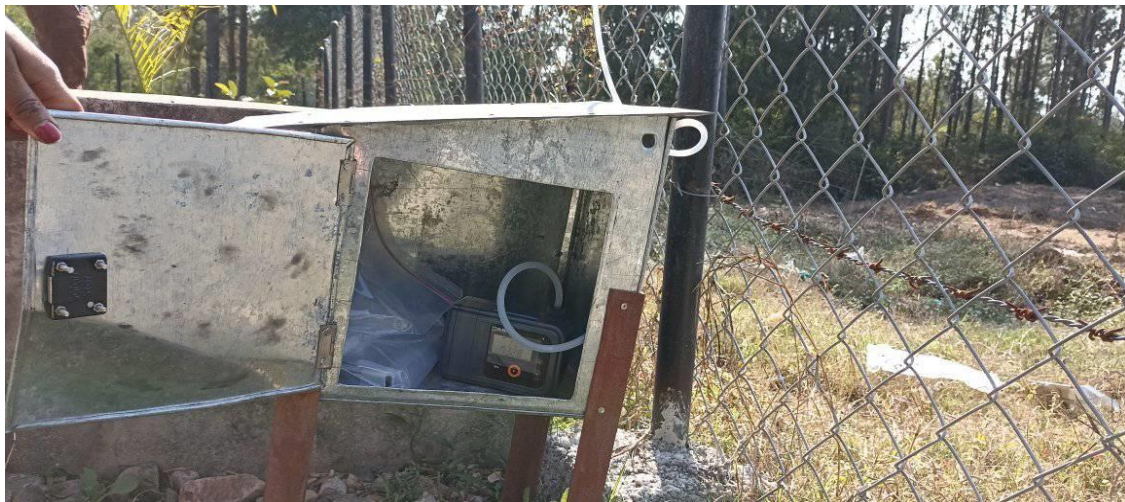
Gold amalgamation trap method बाट वायुको नमूना संकलन गर्दै
